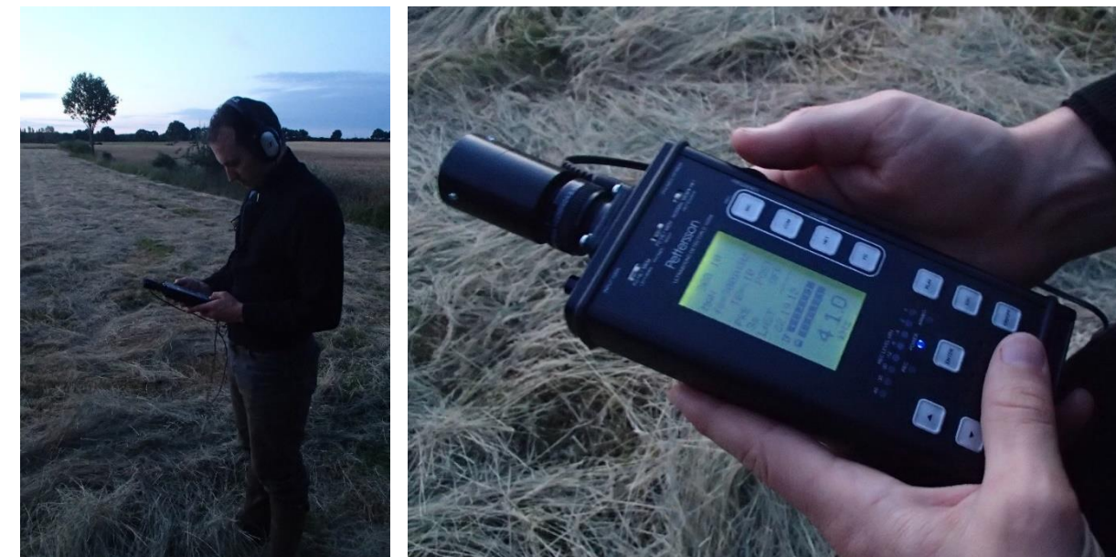
Figure 10 : Point d'écoute de 20 min à la batbox Pettersson D1000X
