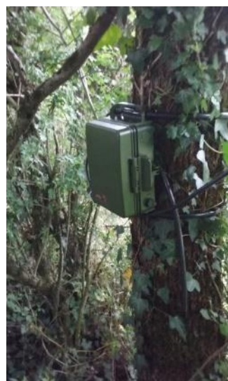
Figure 11 : Installation d'enregistreur continu SM4BAT
